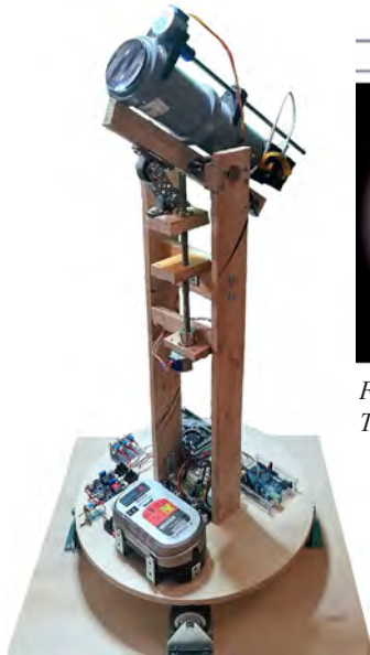
Das selbstgebaute Sonnenteleskop von Dominik (JuFo25)
